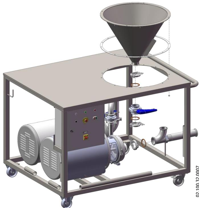
4. Abrir la abrazadera tubo (38A) liberando el tubo venturi (102). A continuación quitar la abrazadera clamp (91) y la junta (91B) que fijan la tubería venturi (102) al cuerpo de la bomba (01).
